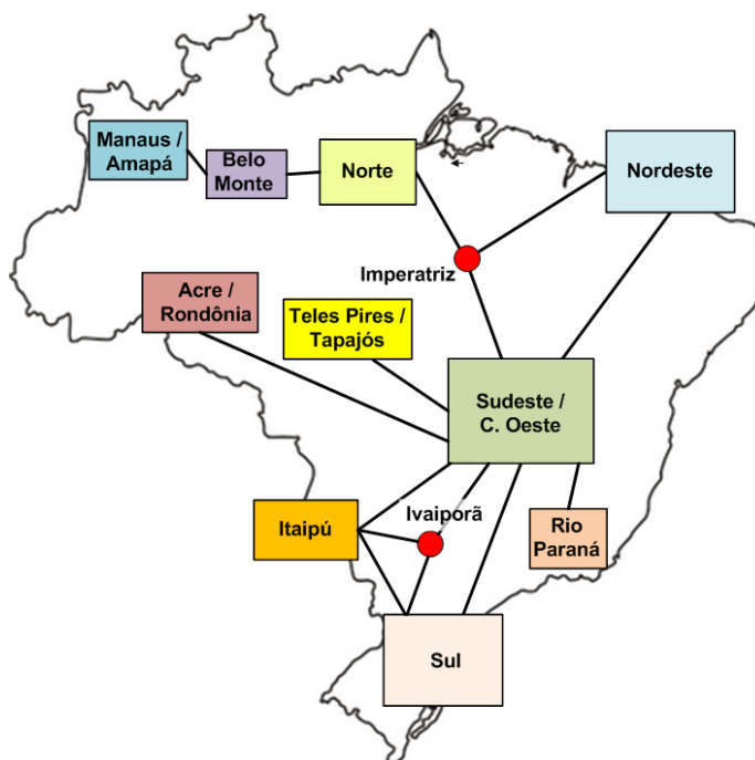
Figura 4.8 - Configuração dos subsistemas do SIN no PDE 2020 (Fonte: PDE 2020)
