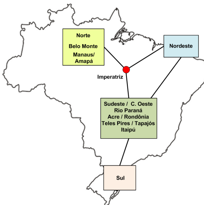
Figura 4.9 - Configuração dos subsistemas do SIN para o PGF (Fonte: PDE 2020)
